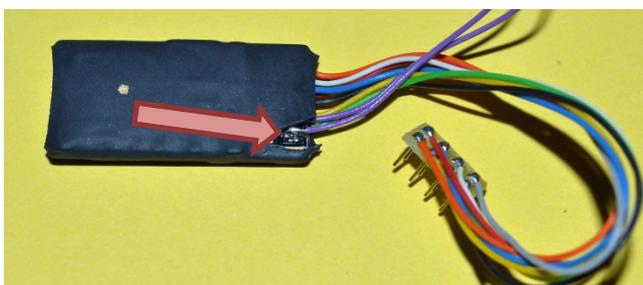
OEM MX645R Sounddecoder vorsichtig von der NEM652 Schnittstelle abziehen und ablegen. Die Schutzhülle zur Freilegung vom FA2 Lötpad aufschneiden. Eine braune Litze neben der Violetten auf das Lötpad löten (Pfeil **braun**).
