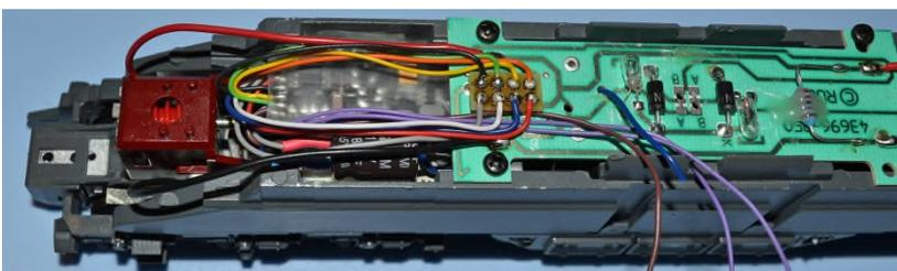
Einen vorhandenen Schnittstellenstecker einsetzen und die Litzen vom Sounddecoder, lagerichtig wie im Bild sichtbar, beginnend mit der orangen Litze bei der ★ Markierung, anlöten.
