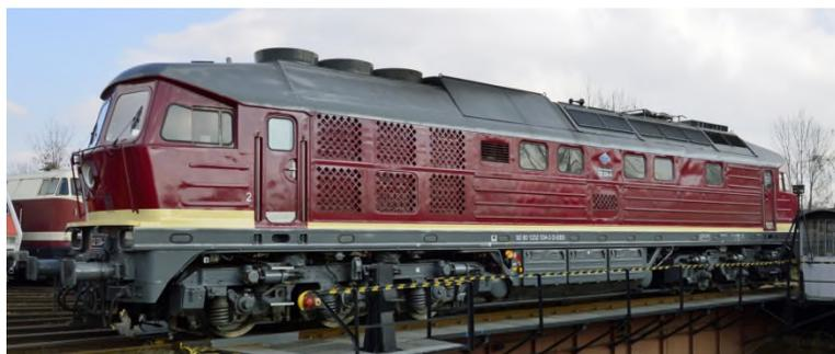
Die DR Ost importierte ab 1970 aus der Sowjetunion eine weitere Diesellokvariante, die BR 130 bis 132. Diese Lokomotive sollte mit über 800 gebauten Exemplaren der erfolgreichste Typ werden und löste die Dampflokomotiven in der DDR ab. Die BR130–132 wurden im Volksmund „Ludmilla“ genannt. Während die 130 und 131 noch ohne elektrische
